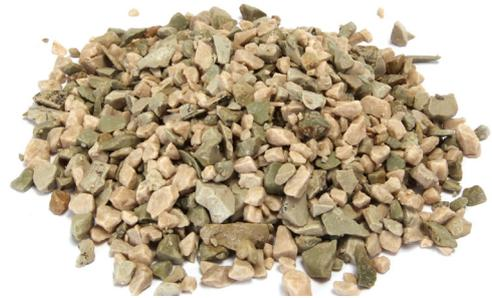
Bei den üblicherweise als Filtersubstrat eingesetzten Zeolithen handelt es sich um Natur-Zeolithe mit einem hohen Klinoptinolith-Anteil. Die Entstehung dieser Zeolithvorkommen ist auf die Verwitterung von vulkanischen Aschen und Tuffen oder basaltischen Gesteinen zurückzuführen. Diese können terrestrisch oder marin abgelagert sein. Viele Lagerstätten sind auch auf metamorphe Sedimente zurückzuführen.
